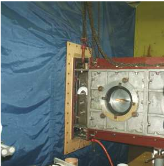
Rys. 4 Widok tunelu wraz z podłączonym zbiornikiem elastycznym
