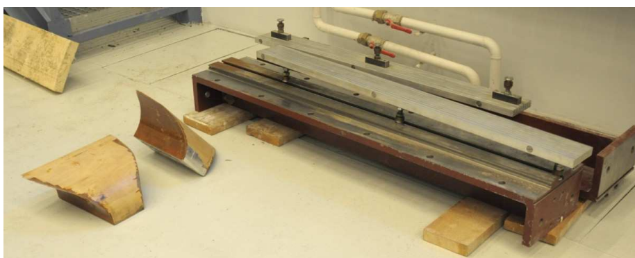
Rys. 3 c Widok ścianki górnej i dolnej tunelu, ścianek przepuszczalnych dyszy komory pomiarowej oraz elementy starej dyszy wlotowej górny i dolny
