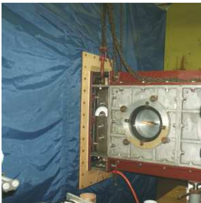
Rys. 4 Widok tunelu wraz z podłączonym zbiornikiem elastycznym
