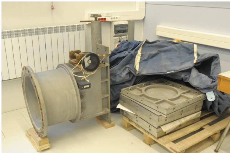
Rys. 3 b Widok płyt bocznych, zbiornika elastycznego oraz starego zaworu dławiącego
